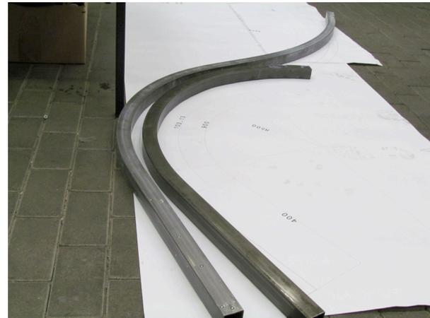
Abbildung 4: Darstellung der Maßabweichung des gebogenen Profils
