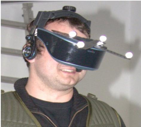
Abb. 3. HMD mit angefügten Infrarot-Markern
