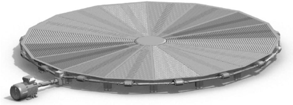
Abbildung 2. CAD Modell des omnidirektionalen Bodens
